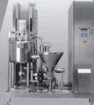
Universelle Technikanlage für Entwicklung und Herstellung von Suspensionen und Emulsionen, Chargengröße 100 l
