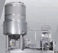
Prozessanlage für kosmetische Vorprodukte, Chargengröße 6.000 l
